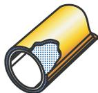
Stahlrohr mit Kunststoffmantel (ABS)
